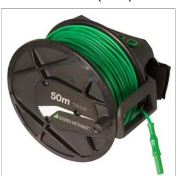
50 m Messleitung, aufgewickelt auf eine Kunststofftrommel. Der Anschluss an das eine Ende der Messleitung ist über zwei in die Trommel integrierte Buchsen möglich. Das andere Ende ist mit einem Bananenstecker ausgerüstet.
